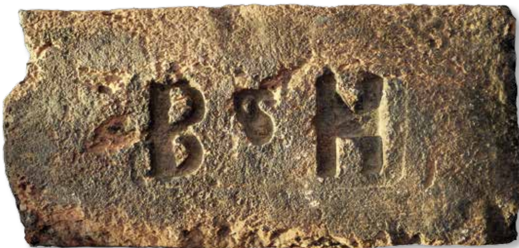
Obr. 11. Cihla s kolkem B H (Bedřich Hofman?), vyrobená patrně v cihelně Juliska (Horní Juliska), vel. 30 × 14,5 × 7 cm, negat. reliéf. Nalezeno: rozpadající se zahradní zídka v ulici Na Vlčovce (foto J. Zavřel, 2016).
