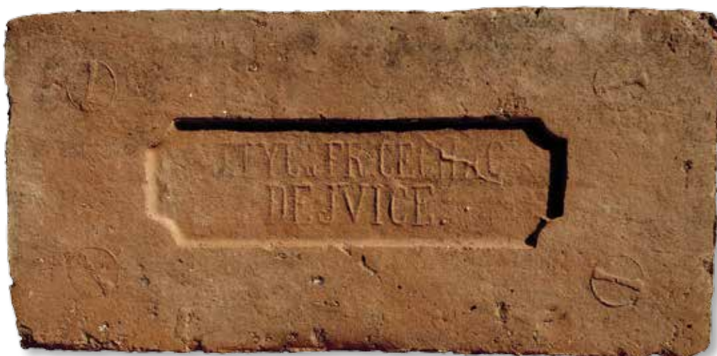
Obr. 8. Cihla s kolkem J. TYL & FR. CECHAC DEJVICE z cihelny Kotlářka, vel. 29,2 × 14 × 7 cm, pozitivní reliéf písma ve vtlačené kartuši. Nalezeno: torzo zahradního domku v ulici V Šáreckém údolí v Dejvicích (foto J. Zavřel, 2016).
